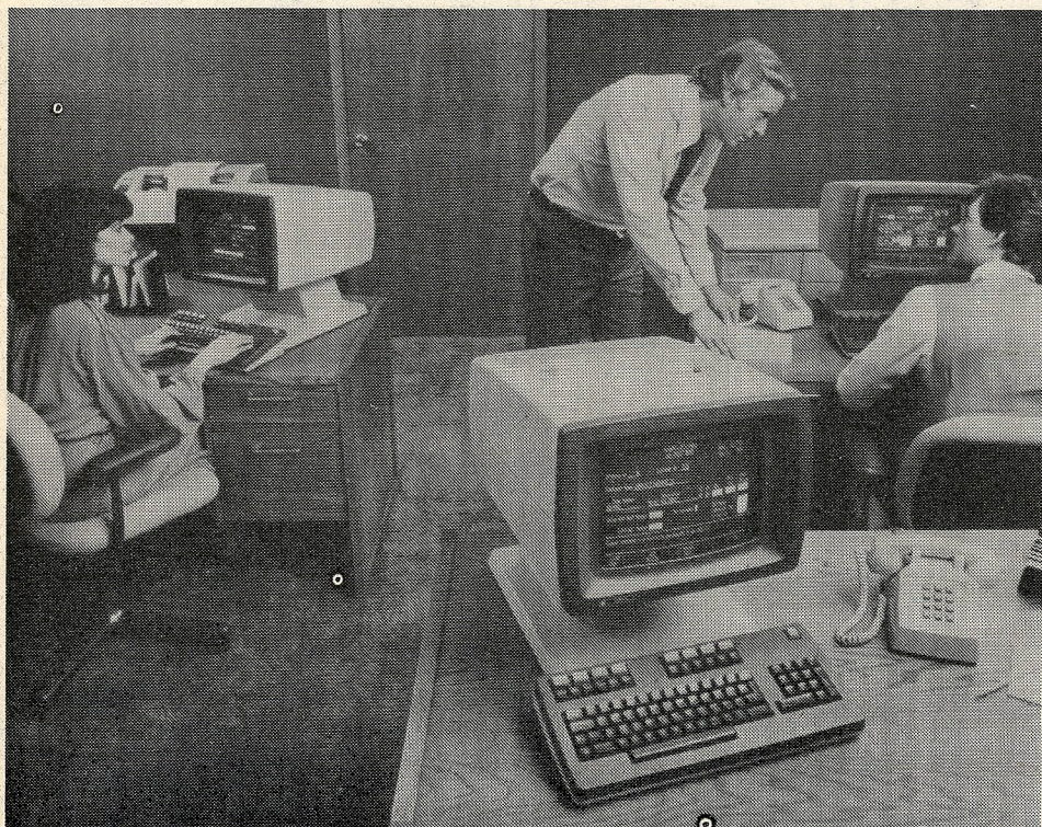
HP 250/30-system med 4 arbejdspladser. Processor-kabinetet ses i baggrunden. Model 35 har integreret hovedstation med tilkobling af indtil 5 arbejdspladser af samme type som Model 30-skærmterminaler.
